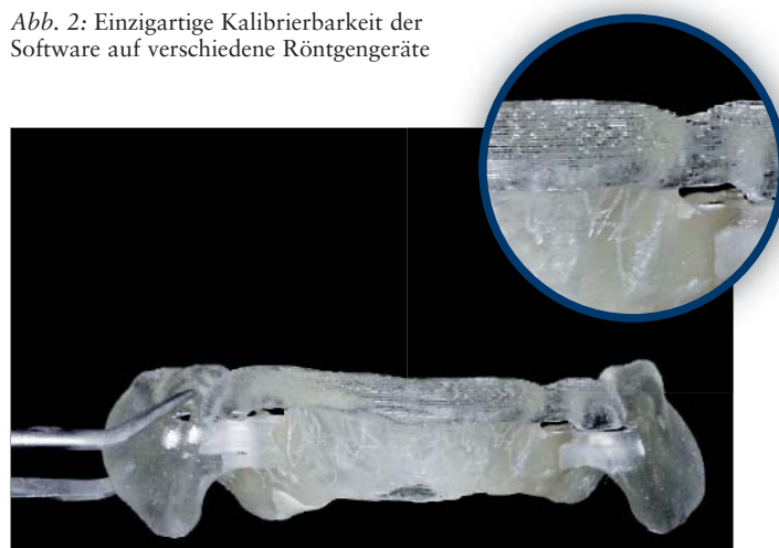
Abb. 4: Schichtstruktur der stereolithografisch erstellten Schablone
